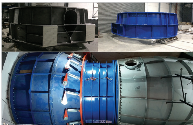
Vodní elektrárna na pražském ostrově Štvanice prošla modernizací tří kaplanových turbín o instalovaném výkonu 3x 1,89 MW. Společnost Metalkov prováděla kompletní povrchovou úpravu všech nadrozměrných dílů, z nichž některé mají až 5 metrů v průměru. Konstrukci turbín vyrábí firma Mavel z Benešova u Prahy. (Foto: Archiv Metalkov Vlašim)
