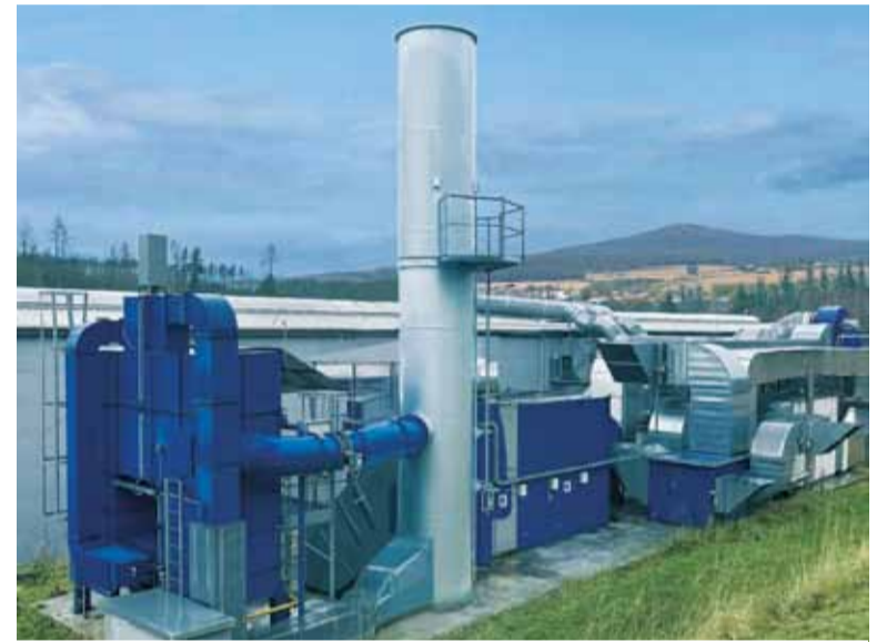
Ze spalovny odpadních těkavých látek VOC vychází čistý vzduch zbavený všech odpadních látek vznikajících při povrchových úpravách
