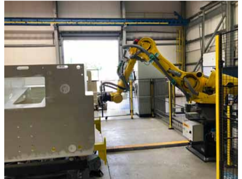
Obr. 3: Robotická bruska s výměnnou brusnou hlavou na předúpravu konstrukcí
